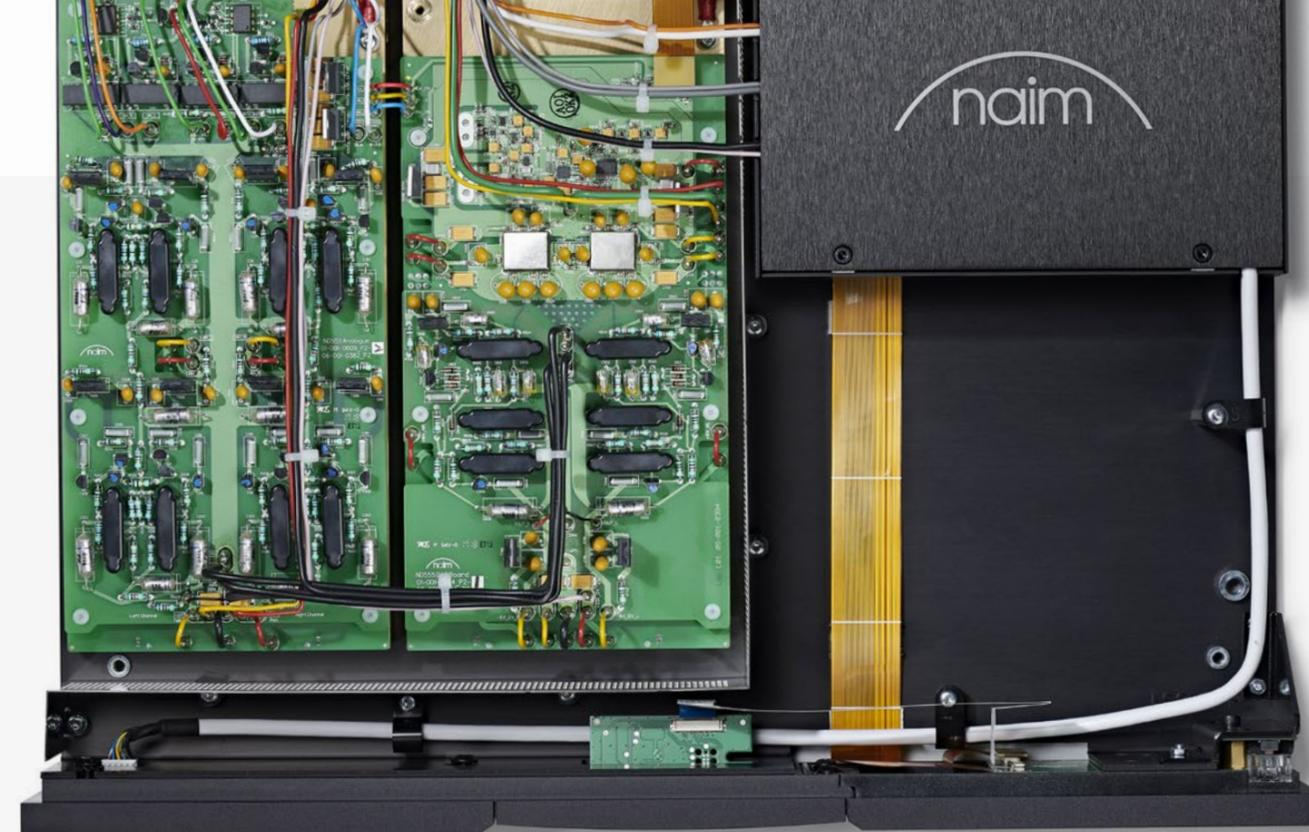
△ INSIDE THE ND 555 — THE NESTED FARADAY 'CAGE' FOR THE DIGITAL CIRCUITS CAN BE SEEN AT TOP RIGHT.
